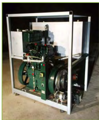
A Crofter Mini Erőmű prototípusa Fotó: Crobell Kft.
