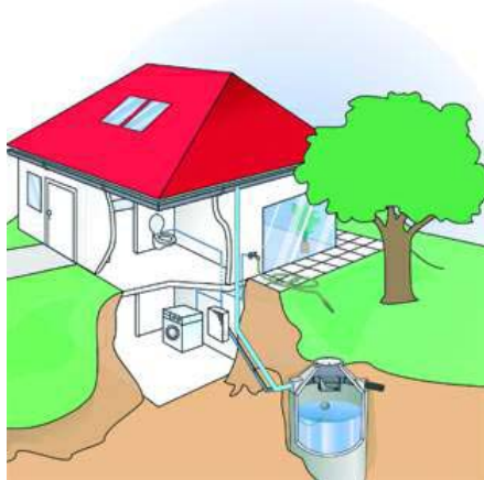
34. ábra: Házi esővízgyűjtő rendszer vázlatos felépítése
